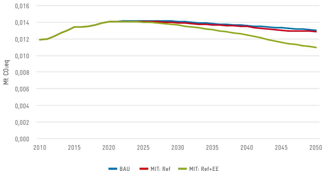
FIGURE 31: TOTAL ANNUAL EMISSIONS FROM DOMESTIC REFRIGERATION 2010-2050, BAU AND MITIGATION SCENARIOS
