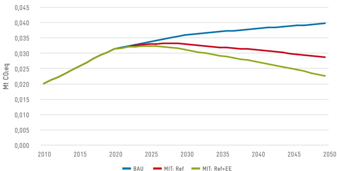
FIGURE 32: TOTAL ANNUAL EMISSIONS FROM COMMERCIAL REFRIGERATION 2010-2050, BAU AND MITIGATION SCENARIOS
